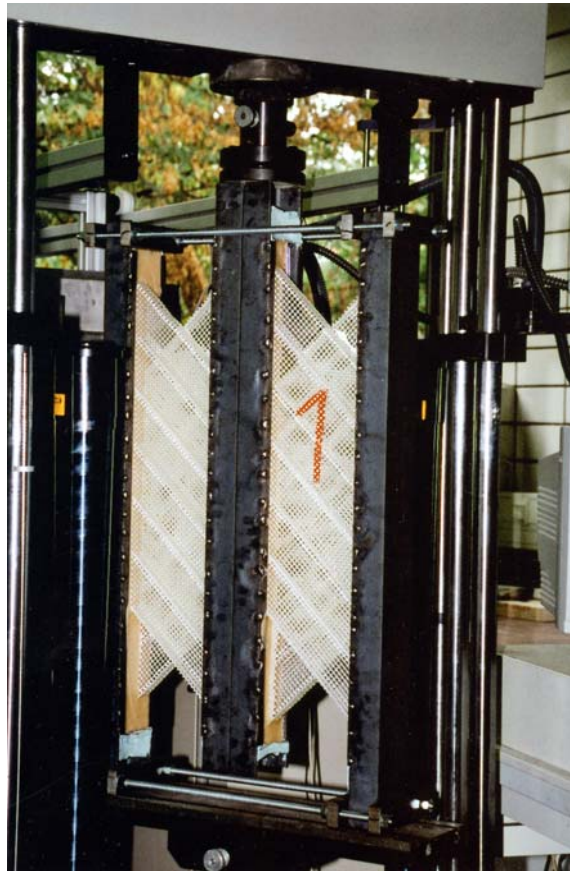
Abb. 3: Schubprüfung an einer zweilagigen \pm 45^\circ PEKATEX®-Stegkonfiguration
